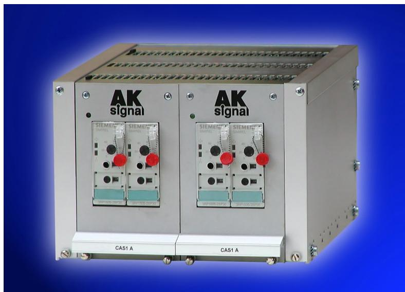
Jednotka CAS1 je konstrukčně řešena jako modulová zásuvná karta. Pro aplikace v reléových stojanech se dodává v kazetě FAK28. Tato kazeta pojme dvě jednotky CAS1 a zabírá dvě pozice pro malorozměrová relé. Přední panel časových relé s nastavovacími prvky je překryt průhledným krytem s možností plombování pro zjištění nežádoucí manipulace s jednotkou.
